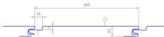
PREFA Alu-Fassaden-Siding Elementbreite 200 mm x 1,0mm
