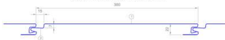
PREFA Alu-Fassaden-Siding Elementbreite 300 mm x 1,2mm
