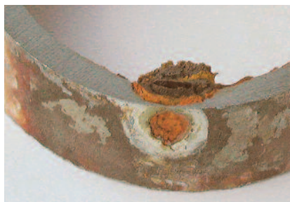
3. ábra – A lyukadási hely környezete a lerakódással [1], és [4] nyomán
