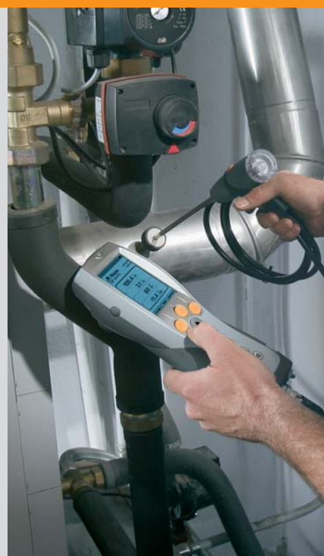
Égőn végzett füstgázmérés
