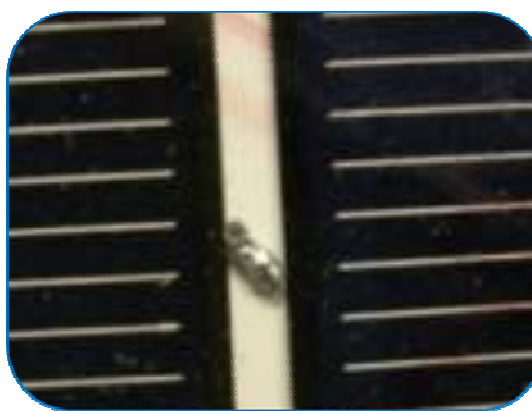
Rövidzár a cellacsatlakozás hibás forrasztása miatt
