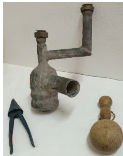
3. kép – A két világháború közti időkből származó ólomszifon és ólomalakító szerszámok az Épületgépészeti Múzeum gyűjteményéből
