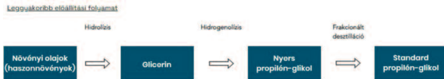
6. ábra – A növényi eredetű propilén-glikol leggyakoribb előállítási folyamata (forrás: Vettő Kft.)
